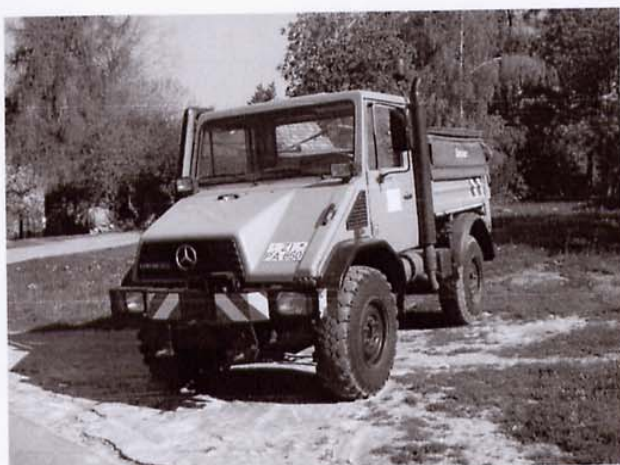
Unimog U130 mit Streuaufsatz für den Winterdienst
