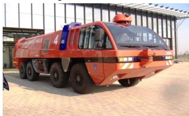
Der große Panther der mit 2 Tanks ausgestattet ist (Wassertank, Schaumtank) hat sogar einen Schnellstartknopf der neben der Tür ist. Im Einsatz sind die Tanks innerhalb von 3 Minuten verbraucht.
