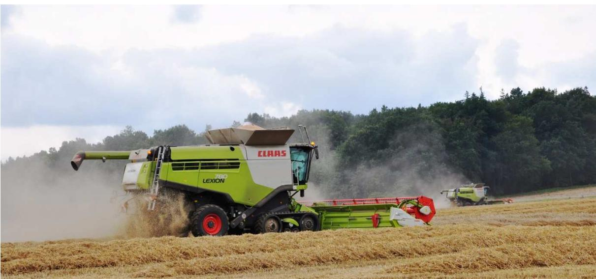
Mit einer Motorleistung von 598 PS, einem Korntankvolumen von 12.500 Liter und einem 12 m Schneidwerk sind die Mähdrescher der Agrofarm Herwigsdorf ausgestattet.
