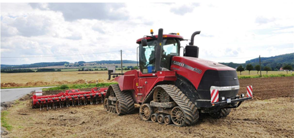
Ein Traktor „Quadtrac 600“ mit einer 12 m Kurzscheibenegge zur Stoppelbearbeitung
